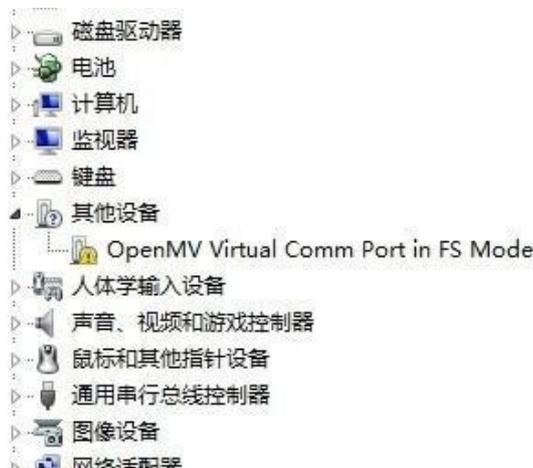
首先下载驱动: <http://pan.baidu.com/s/lpKQd59L> 解压到桌面, 然后右键设备管理器中的这个设备, 然后点升级驱动:
