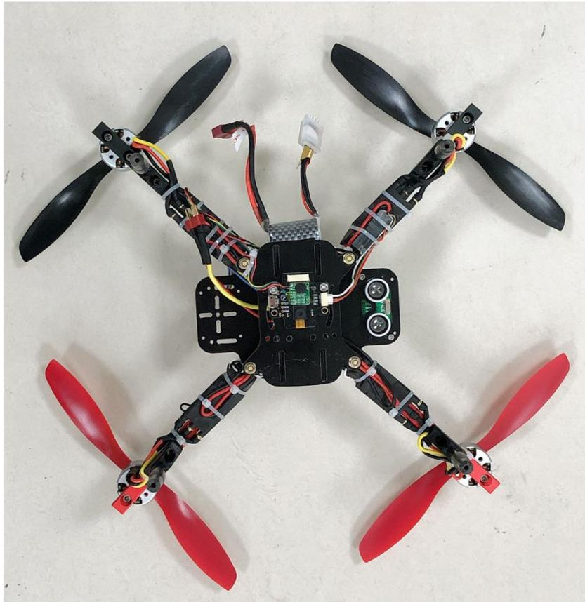
**整机到手飞客户请按上图装好正反浆，务必拧紧，防止射浆炸机**
