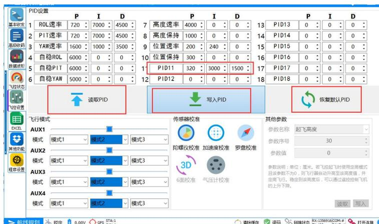
首次使用时，打开飞控设置子窗口，点击读取 PID，即可获取飞控当前的 PID 参数，
