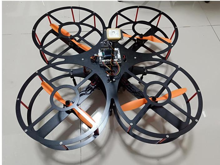
当需要用到外部磁力计时，磁力计数据可以通过预留 IO 口接入飞控，磁力计原始数据需要根据和飞控机头相对角度，进行重映射。结合磁力计类型、安装方向自行调整。
