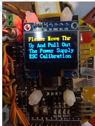
完成上述操作后，（卸掉电机上的螺旋桨，一定要切记，避免血肉模糊），需重新插上总电源，注意插的时候不能抖动，避免反复给主板供电后，导致电调行程校准失败。对于第一代飞板控，可在拔掉电池时先将主板供电开关切到断开状态，再插上电池电源
